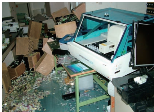
写真1 標本棚の倒壊と検査機器の被害
